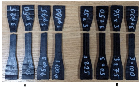
Рис.23. Зразки ABS після статичного випробування на розтяг виготовлені з: а-філаменту; б-подрібнених полімерних відходів
