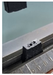
Рис.18. Процес одновісного розтягу лопаток: а-ABS пластик; б-TPU пластик
