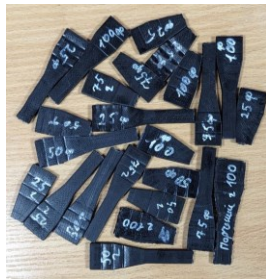
Рис.24. Зразки ABS та TPU пластиків після статичного випробування на розтяг виготовлені з філаменту та подрібнених часток полімеру: а-ABS; б-TPU
