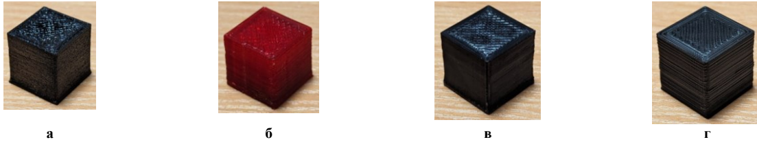
Рис.27. Тестові зразки виготовлені методом 3D-друку із полімеру: а-TPU (філамент); б-TPU (подрібнена частка); в-ABS (філамент); г-ABS (подрібнена частка)
