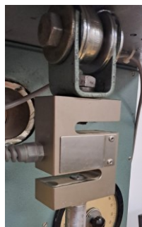
Рис.6. Тензометричний датчик TedeA 619 фірми Vishay
