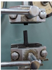
Рис.18. Процес одновісного розтягу лопаток: а-ABS пластик; б-TPU пластик
