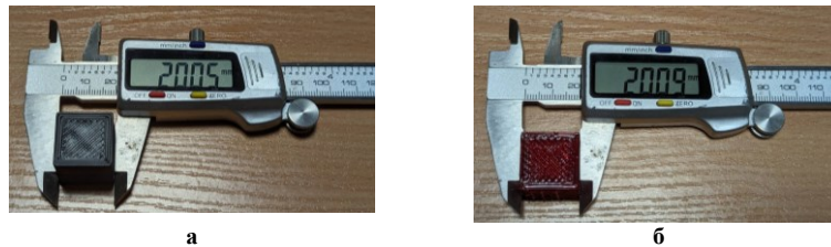
Рис.28. Вимірювання надрукованих зразків за допомогою цифрового штангенциркуля: а - ABS (подрібнені відходи); б- TPU (подрібнені відходи)
