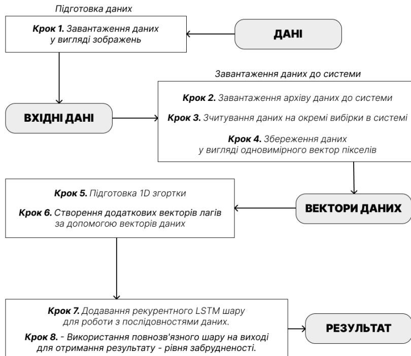
Рис. 3. Схема неймережевої моделі визначення рівня забруднення
