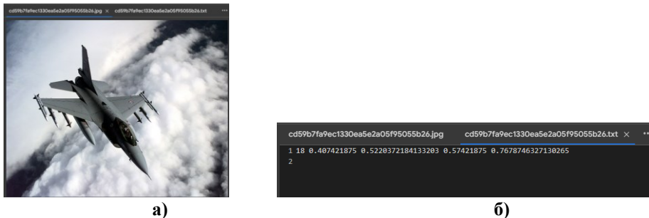
Рис. 2. Візуалізація формату файлів: а) Вихідне зображення; б) Файл з анотаціями
