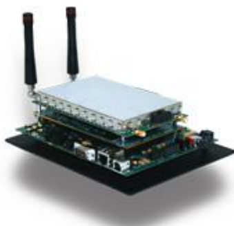
Рис. 4. Зовнішній вигляд платформи SFF фірми Lyrtech у технології SDR. [3].
