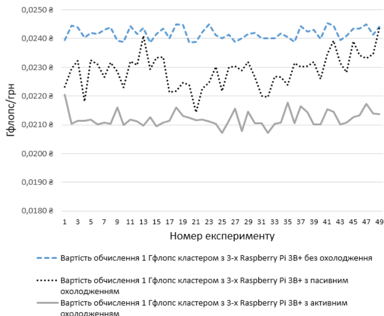
Рис. 2. Вартість обчислення 1 Гфлопс кластерною системою на базі трьох одноплатних комп'ютерів Raspberry Pi 3B+ під час виконання тесту “High performance challenge benchmark” та при використанні різних підходів до охолодження кластера
