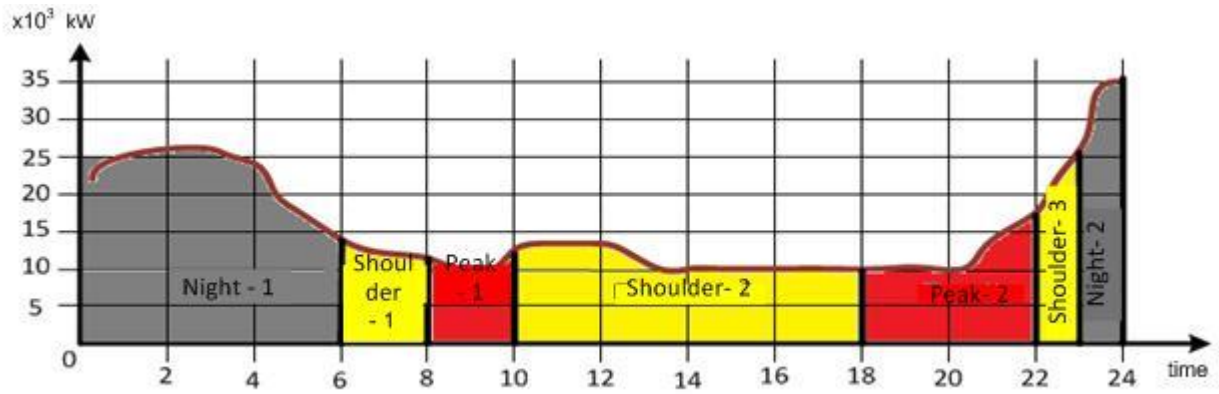
Рис. 7. Добовий графік навантаження активної потужності шахт ПАТ «Криворізький залізрудний комбінат», 2021р. м. Кривий Ріг
